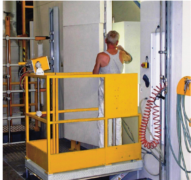
5 Diese Scherenhebebühne hat eine maximale Arbeitshöhe von einem Meter. Der Bediener ist – z. B. bei einem Fehltritt nach hinten – dank des Geländers auf der gesamten Hubhöhe vor einem Absturz gesichert. Je nach Arbeitsplatzsituation kann ein Geländer bereits bei einer geringeren Absturzhöhe als 500mm erforderlich sein.
